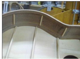
Εικόνα 10. Πλαϊνά καμάρια στήριξης. (Ε. Παπαδόπουλος, Φωτογραφία από το εργαστήριο του Γ. Καρελλά)
