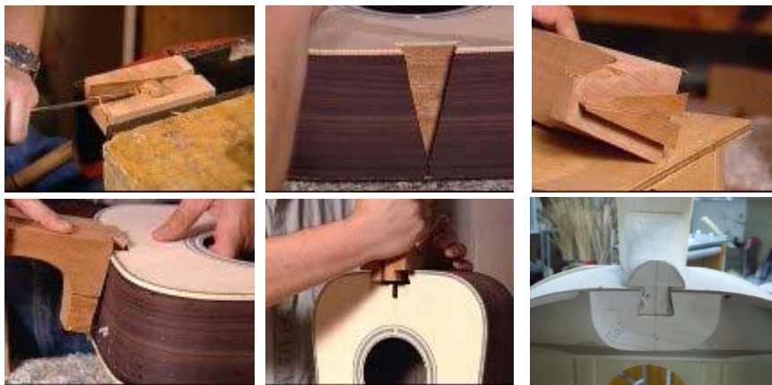
Εικόνα 20. Ένωση του βραχίονα με το σκάφος. Η μέθοδος με μόρσο. Στην τελευταία εικόνα φαίνεται η ένωση σε λαϊκή κιθάρα. (πέντε πρώτες εικόνες από το διαδικτυακό άρθρο του http://www.diynetwork.com/diy/cda/article_print/0,1983 ενώ η τελευταία από το οργανοποιείο Γ. Καρελλά)
